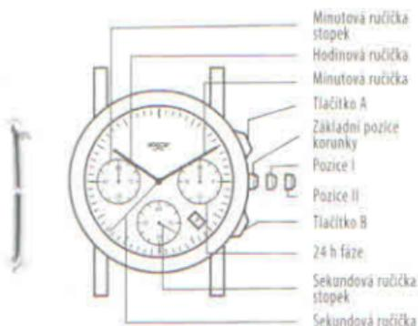
Pozice jednotlivých čítačů chronografu či ukazatele data a dne v týdnu, se u různých modelů liší. Princip nastavení a používání stopek je stejný.
